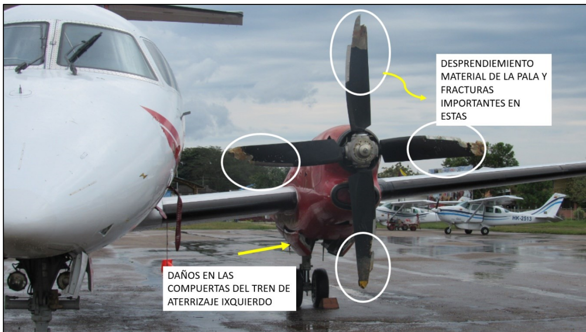
Fotografía No. 2 – Daños encontrados en aeronave HK4973
